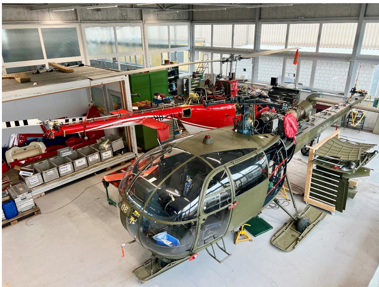
Jet Ranger & Alouette HB-XXM in der Jahreskontrolle
